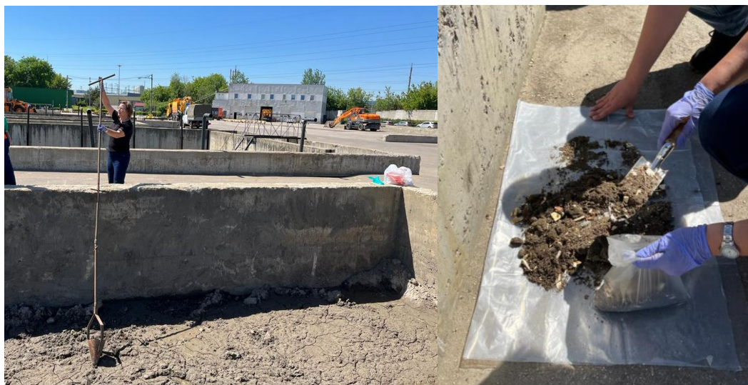
Рисунок 16. – Процесс отбора проб экспериментальной партии Отхода после обезвреживания
