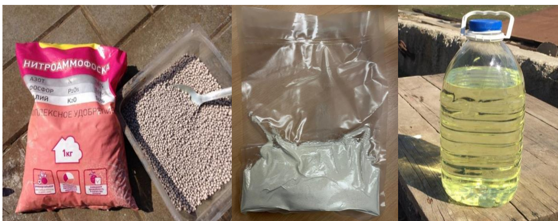
Рисунок 6. – Компоненты для приготовления суспензии (азотсодержащее удобрение, биопрепарат «Деворойл», дизельное топливо)
