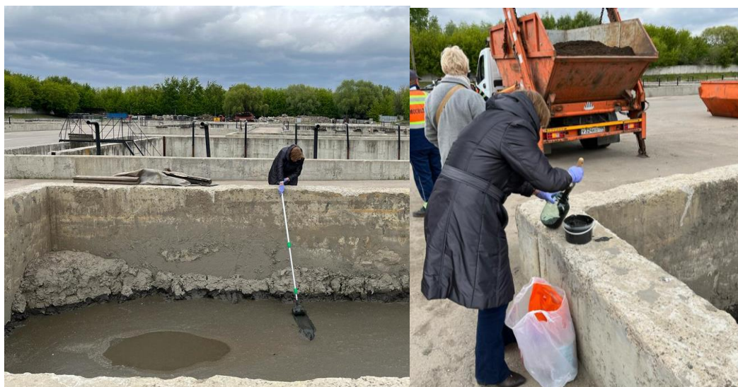
Рисунок 9. – Процесс отбора проб подсушенной экспериментальной партии отходов после деструкции нефтепродуктов биопрепаратом «Деворойл»
